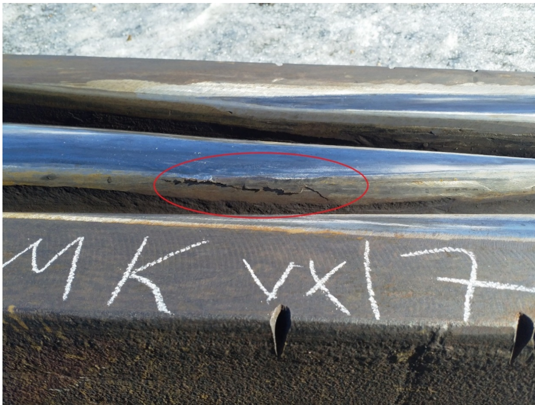
Bild 9 Exempel: Övervalsning spets. - V
