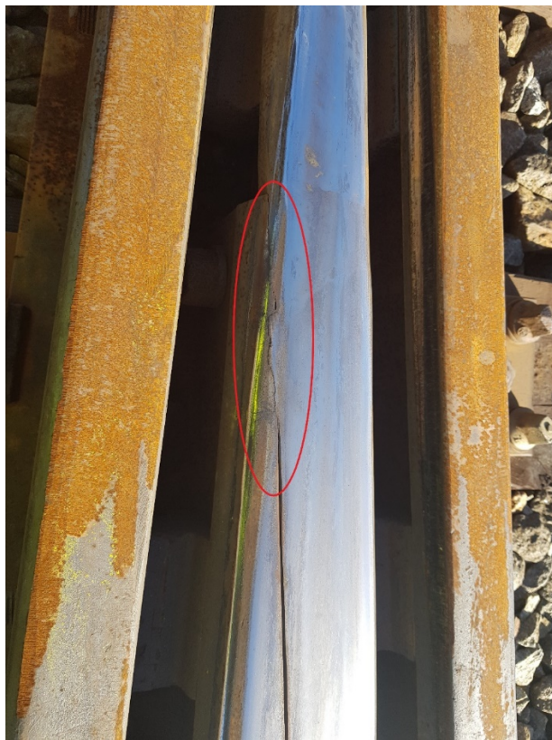
Bild 14 Exempel: Övervalsning mellan spetsröler. - M
