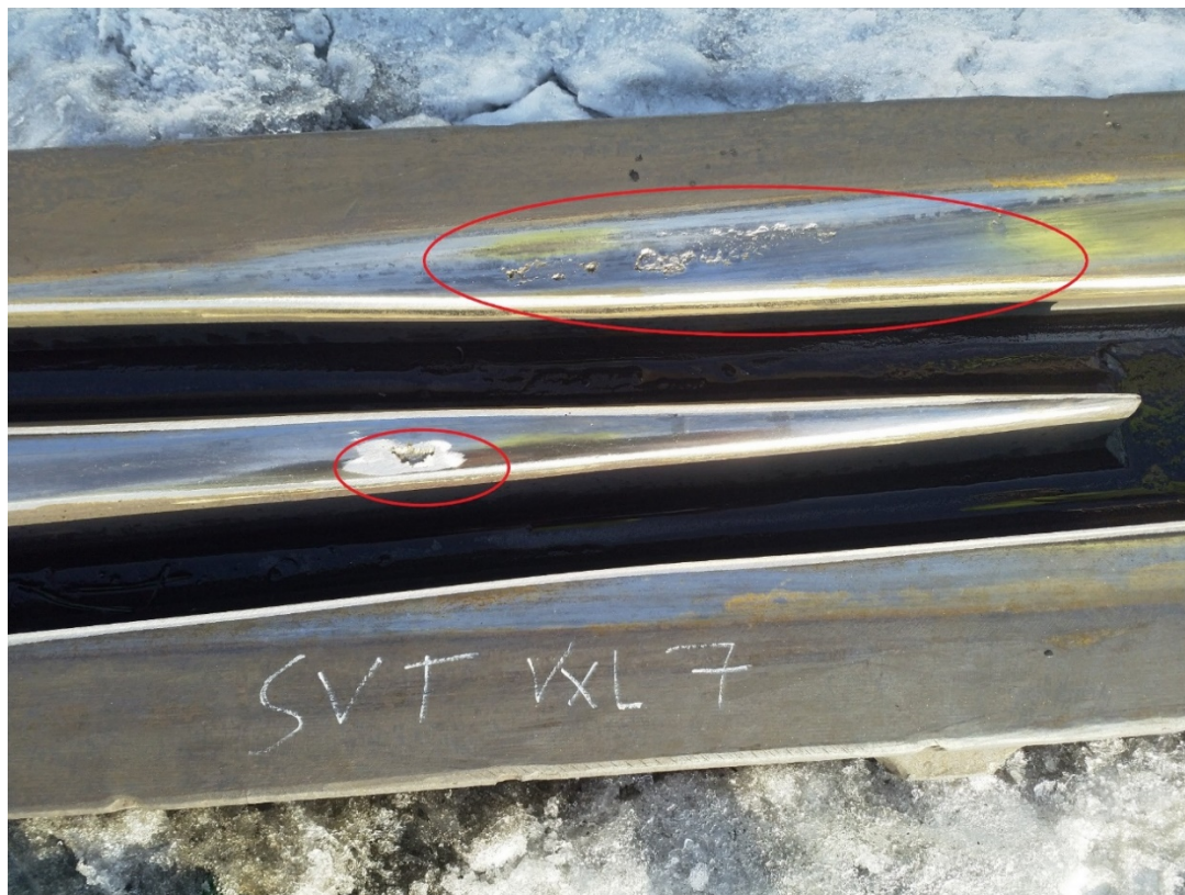
Bild 13 Exempel: Mindre skador spets och vingrål (spalling). - V
